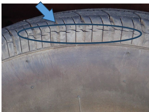
⑱ タイヤ詳細③ひびあり
