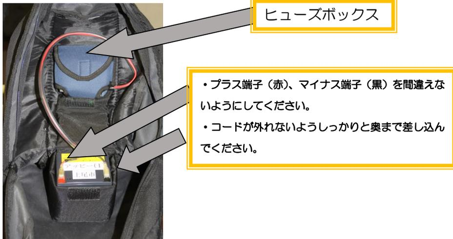
2) ①本体内部のソケットを⑥リュックサック内部のヒューズボックスにつなぎます。つないだ後はロックねじを締め、固定します。
